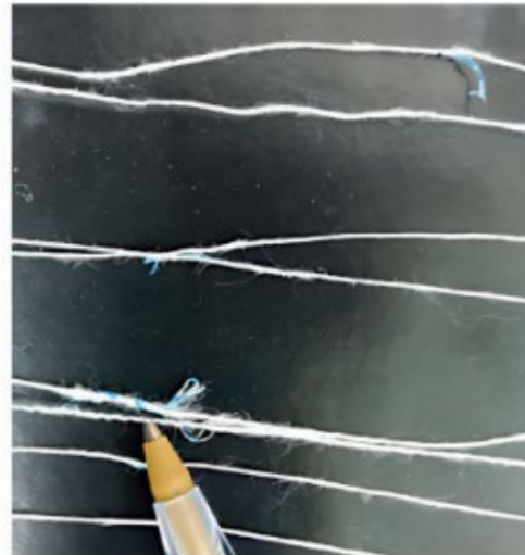
Fio de polipropileno na pluma de algodão
