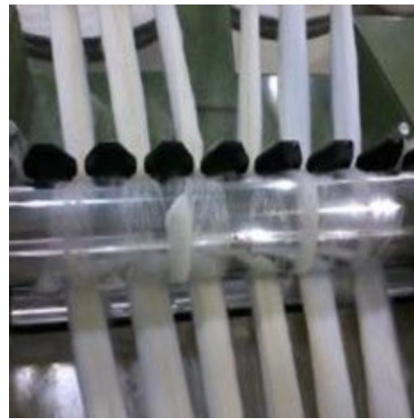
Ineficiência provocada por pegajosidade
