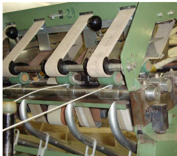
Feltros limpadores na parte superior e limpadores de borracha na parte inferior nas maçaroqueiras
