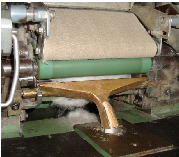
Feltros limpadores na parte superior e limpadores de borracha na parte inferior dos passadores.
